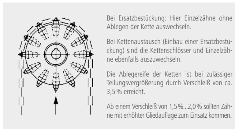
Bei Ersatzbestückung: Hier Einzelzähne ohne Ablegen der Kette auswechseln.
