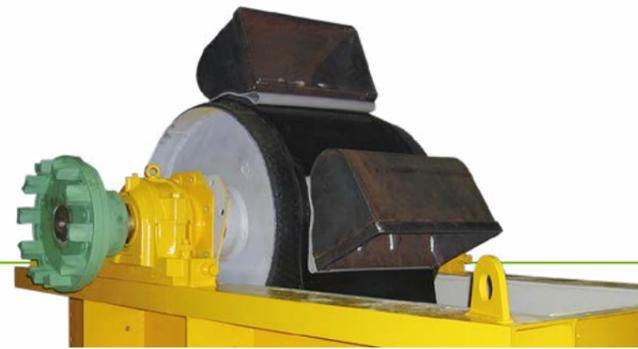
Zum stetigen Senkrechtfördern von schöpfbaren Schüttgütern eignen sich Gurtbecherwerke besonders. Grobkörnigen oder temperaturbelasteten Fördergütern wird durch geeignete Maßnahmen Rechnung getragen. Stabile Gurte mit Gewebe oder Stahleinlagen transportieren das Fördergut staubfrei und problemlos auch über größere Förderhöhen.
