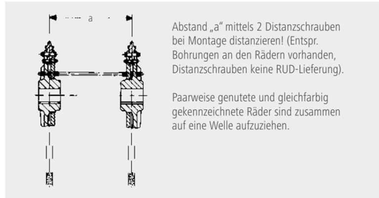
Abstand „a“ mittels 2 Distanzschrauben bei Montage distanzieren! (Entspr. Bohrungen an den Rädern vorhanden, Distanzschrauben keine RUD-Lieferung).
